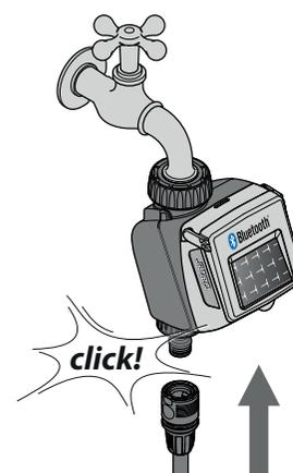
Raccordez les lignes d'arrosage à la prise du programmeur à l'aide d'un raccord Quick-Click System ou d'un raccord fileté de 3/4".
